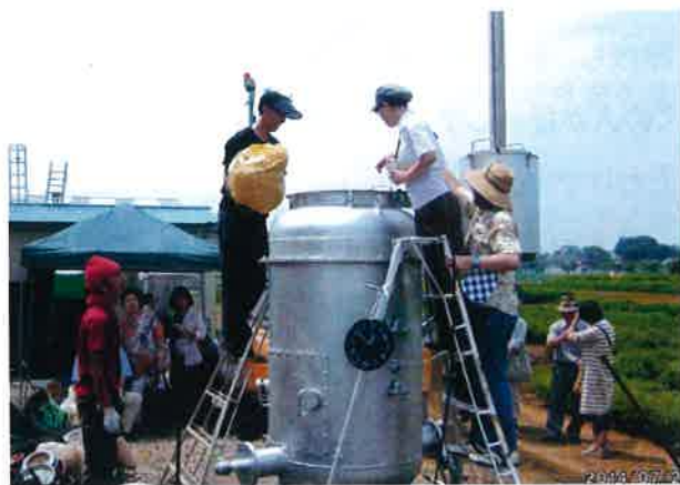
◆電子のパワーで廃棄物を処理 公開実験 無燃料処理装置 「オメガスパイラルズ」
